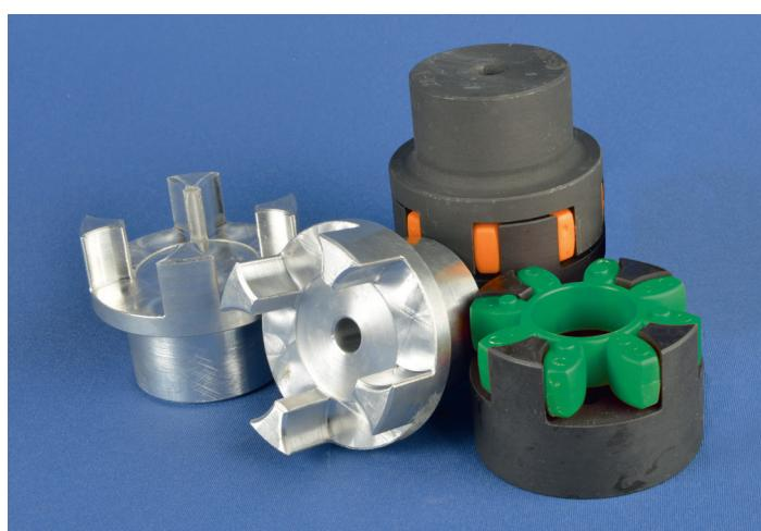
RPX/Habix® plus Kupplungen bestehen aus zwei Kupplungsnaben mit konkav ausgebildeten Mitnahmeklauen, die mit hoher Rundlaufgenauigkeit produziert werden und einem Stern, der aus einem extrem verschleissfesten und temperaturbeständigen Kunststoff gefertigt wird. Bis zur Grösse 48 wird die Kupplung aus hochfestem Aluminium, ab Grösse 65 aus Stahl gebaut.
