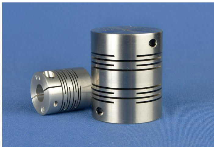
Die Mini-Kupplung ist eine spielfreie, drehsteife, biegeelastische und vor allem wartungsfreie Ganzstahlkupplung, die aus einem Stück gefertigt ist. Sie ist speziell geeignet für Antriebssysteme, die auf kleinem Bauraum hochdynamische Prozesse steuern und regeln. Dieses betrifft den gesamten Maschinenbau sowie Transferstrassen, Medizintechnik, Roboter und auch den Modellbau.
